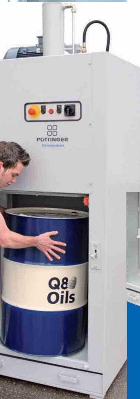
Se compacta con facilidad los bidones de acero de hasta 200 litros con el factor 20:1. Las cámaras cerradas cuidan de un lugar de trabajo limpio. Se acumula los restos de líquidos en un recipiente recogedor.
